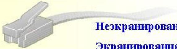
Витая пара – наиболее дешевый вид кабеля. Витая пара позволяет осуществлять максимальную скорость передачи до 10 Мбит/с. Длина кабеля не должна превышать 1000 метров, причем скорость передачи данных при этом не превысит 1 Мбит/с. Для повышения помехозащищенности используют экранированную витую пару. Каждая витая пара соединяет с сетью только один компьютер, поэтому нарушение соединения сказывается только на этом компьютере, что позволяет быстро находить и устранять неисправности.
