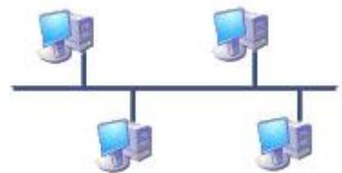
Структура типа «шина» проще и экономичнее, так как для нее не требуется дополнительное устройство и расходуется меньше кабеля. Но она очень чувствительна к неисправностям кабельной системы. Если кабель поврежден хотя бы в одном месте, то возникают проблемы для всей сети. Место неисправности трудно обнаружить.
