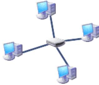
В этом смысле «звезда» более устойчива. Поврежденный кабель – проблема для одного конкретного компьютера, на работе сети в целом это не сказывается. Не требуется усилий по локализации неисправности.
