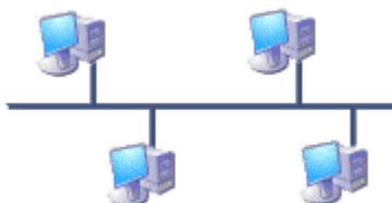
Структура типа «шина» проще и экономичнее, так как для нее не требуется дополнительное устройство и расходуется меньше кабеля. Но она очень чувствительна к неисправностям кабельной системы. Если кабель поврежден хотя бы в одном месте, то возникают проблемы для всей сети. Место неисправности трудно обнаружить.
