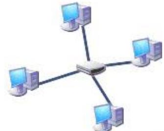
В этом смысле «звезда» более устойчива. Поврежденный кабель – проблема для одного конкретного компьютера, на работе сети в целом это не сказывается. Не требуется усилий по локализации неисправности
