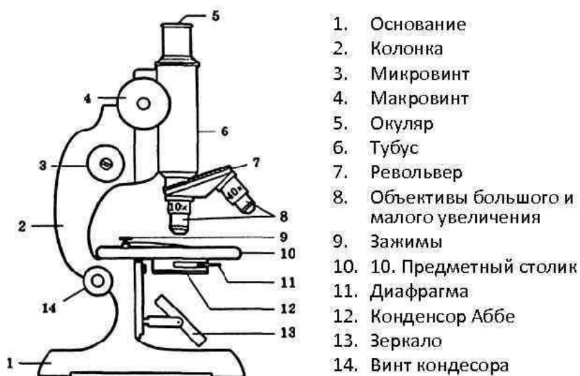
Рис. 1. Устройство микроскопа
