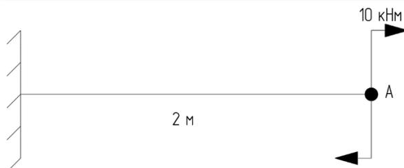
23. Абсолютное значение угла поворота точки A заданной конструкции равно  $X/EI$ , где  $X$  - ...
