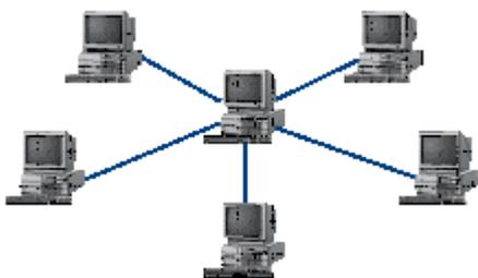
*Звезда* (star), при которой к одному центральному компьютеру присоединяются остальные периферийные компьютеры, причем каждый из них использует свою отдельную линию связи. Весь обмен информацией идет исключительно через
