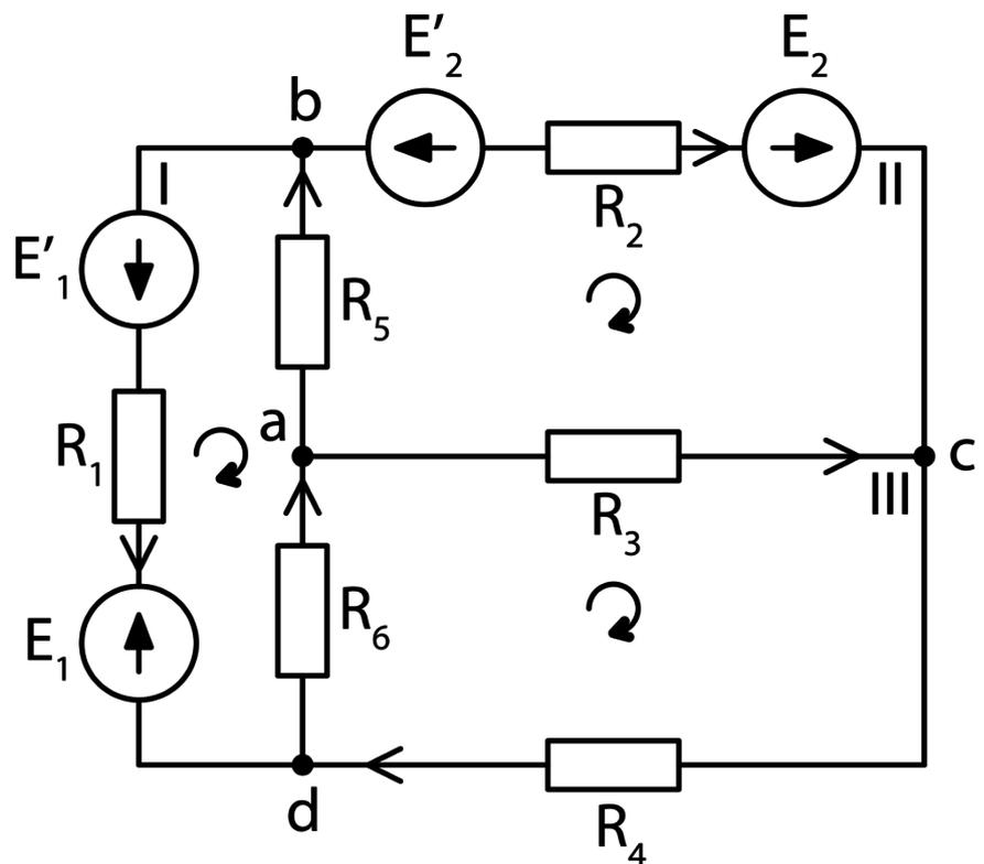
Определяем контурные токи. Ток  $I_{11}$  протекает по контуру, образованному резисторами  $R_1, R_6, R_5$ ; ток  $I_{22} - R_5, R_2, R_3$ ; ток  $I_{33} - R_3, R_4, R_6$ . Направления всех контурных токов выбираем по часовой стрелке (совпадающими с направлениями обходов контуров для второго закона Кирхгофа). Общее сопротивление, входящее в состав первого и второго
