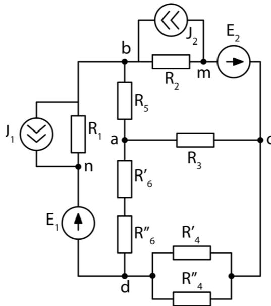
Для упрощения схемы заменяем сопротивления четвертой и шестой ветвей эквивалентными и источники тока  $J_1$  и  $J_2$  – эквивалентными источниками ЭДС.
