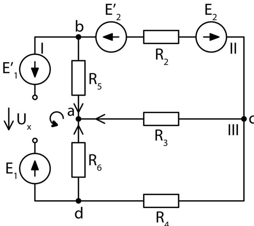
Для определения  $U_x$  составляем уравнения по второму закону Кирхгофа.
