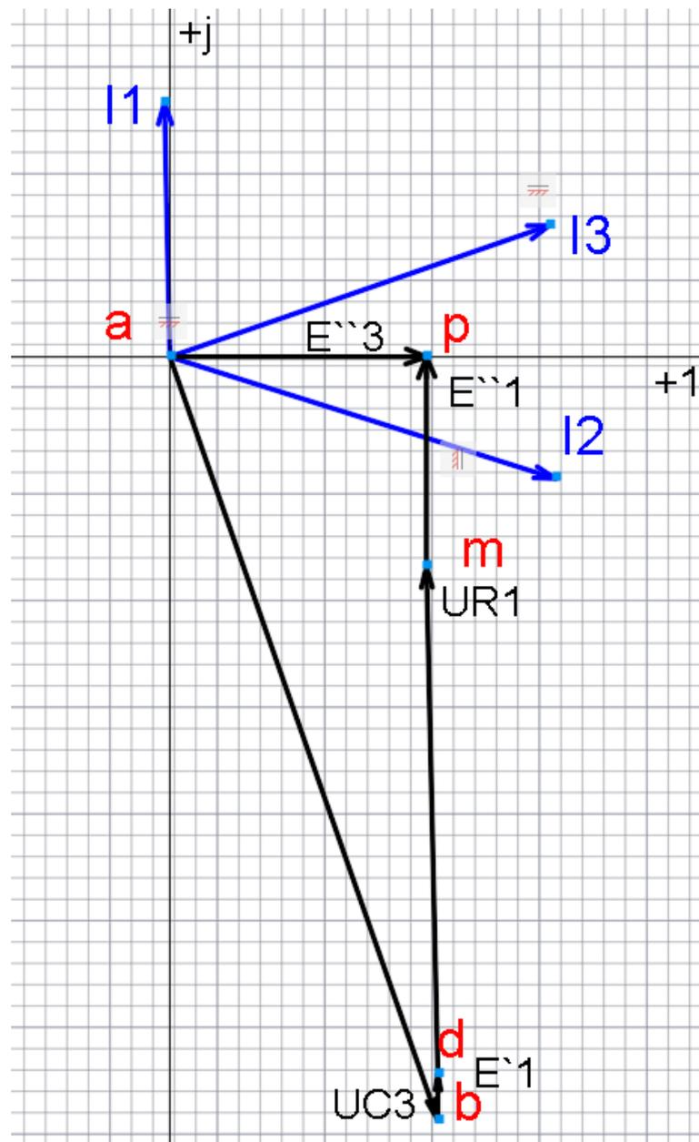
С помощью векторной диаграммы убедились в правильности расчета, так как падение на резисторе  $R_1$  ( $U_{R1}$ ) совпадает по фазе с током первой ветви  $I_1$ , а падение напряжения на ёмкости  $C_3$  отстаёт от тока третьей ветви  $I_3$  на  $90^\circ$ .
