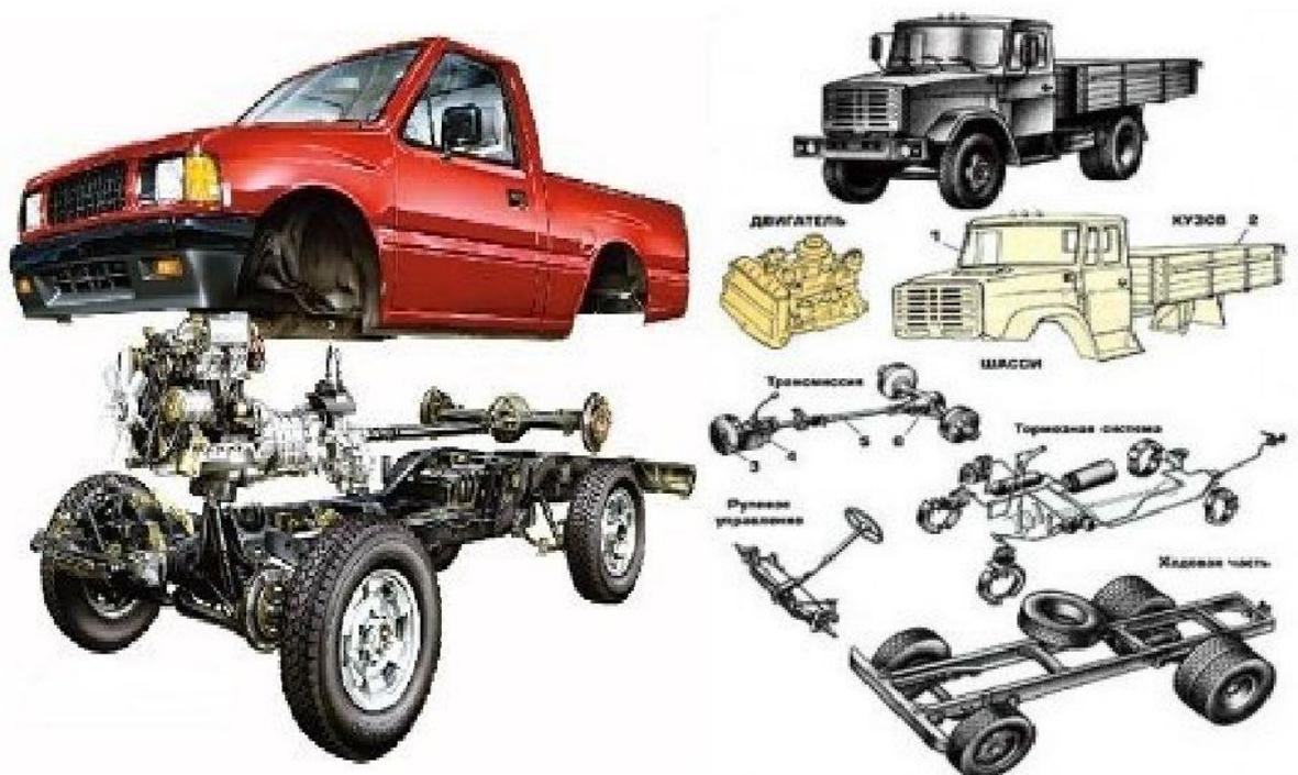
Рисунок 1 – Устройство автомобиля
