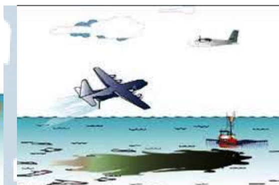
Рис. 27. Типовая схема ликвидации нефтяных разливов на акватории при использовании диспергентов
