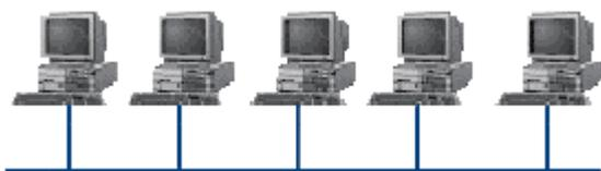
линии связи, и информация от каждого компьютера одновременно передается ко всем остальным компьютерам. Согласно этой топологии создается одноранговая сеть. При таком соединении компьютеры могут передавать информацию только по очереди, так как линия связи единственная.
