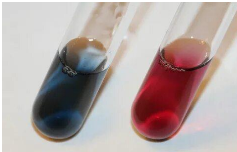
Рис. 7. Изменение цвета раствора при титровании в присутствии индикаторов.
