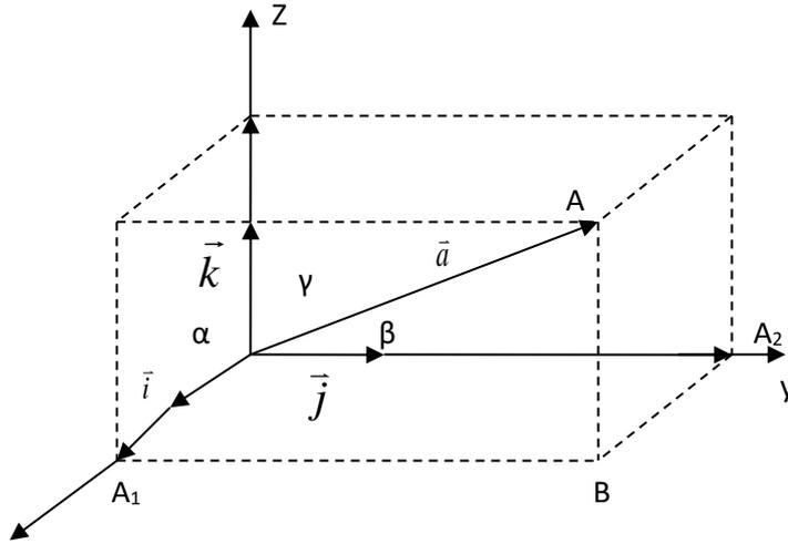
Рисунок 26. Проекция вектора на координатные оси
