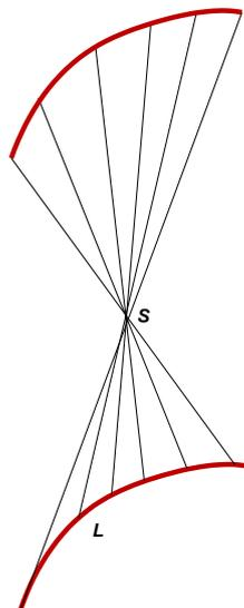
Рисунок 41. Определение конической поверхности
