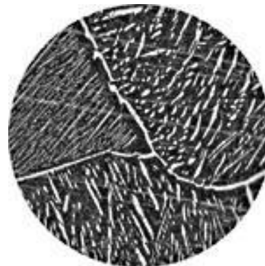
Рисунок 3 – Микроструктура титанового высокопрочного сплава ВТ3-1 (группа \alpha+\beta -сплавов мартенситного класса): а) после закалки и отпуска; б) после закалки и старения – ориентированные частицы \alpha -фазы, возникшие в результате распада мартенситной \alpha' -фазы
