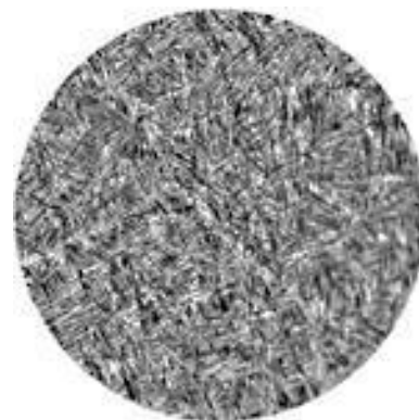
Рисунок 4 – Микроструктура титанового высокопрочного сплава ВТ22 (группа псевдо \beta -сплавов): а) после закалки – зерна равноосные; б) медленное охлаждение из \beta области (отжиг). В результате распада \beta -фазы появились ориентированные пластинки \alpha -фазы
