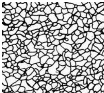
Рисунок 4 – Микроструктура технического железа (феррит), x100
