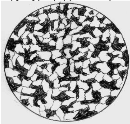
Сталь 40ХМФА – улучшаемая сталь (после нормализации) структура феррит + перлит
