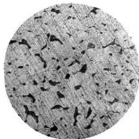
Рисунок 8 – Микроструктура свинцовистой бронзы Бр С30
