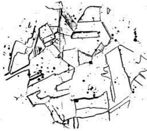
Нержавеющая сталь X18H9T. Закалка с 1080 °С в воде. Хромоникелевый аустенит. х 450
