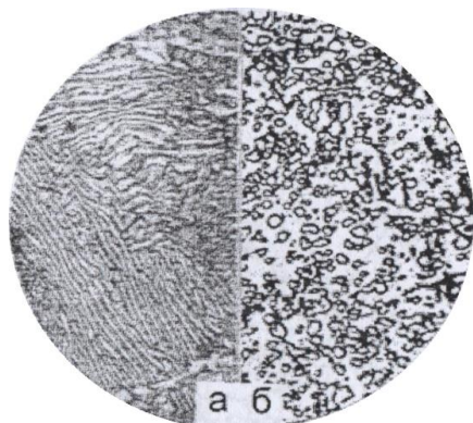
Рисунок 5 – Микроструктура эвтектоидной стали: перлит пластинчатый (а) и перлит зернистый (б)
