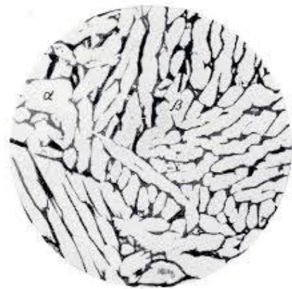
Рисунок 6 – Микроструктура алюминиевой бронзы: а) однофазной (α) деформированной; б) литейной, структура α + эвтектоид (α+γ)
