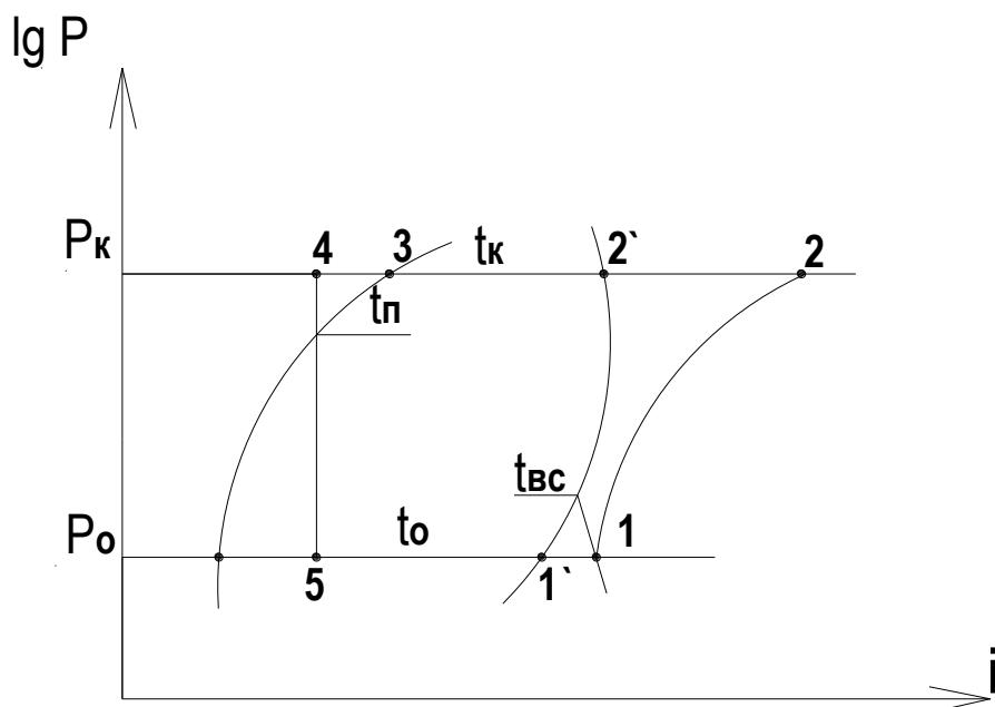
3. После построения цикла заполняется таблица параметров узловых точек цикла.
