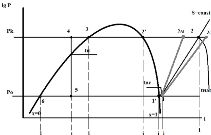
Цикл в диаграмме для винтового компрессора строится аналогично циклу поршневого компрессора. Затем для построения политроп (1-2c) и (1-2m) необходимо определить параметры точек (2c) и (2m);
