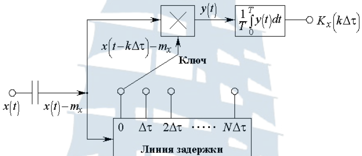
Рис. 4.1. Схема устройства, реализующего последовательное измерение отсчетов корреляционной функции
