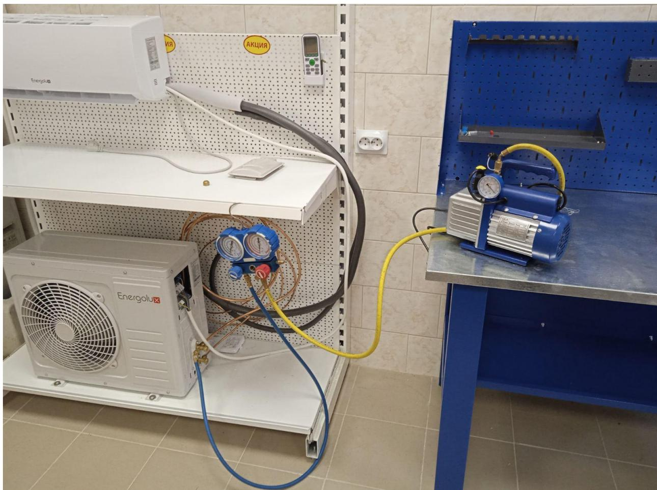
Вакуумирование производят до остаточного давления не более  $1,07 \cdot 10^3$  Па (8 мм.рт.ст.) для фреоновых установок при температуре в рефрижераторном машинном отделении не ниже 10 °С. После достижения указанной величины вакуума, вакуумирование продолжается для обеспечения осушения системы. За
