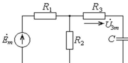
$$R_1 = 2 \text{ кОм}, R_2 = 3 \text{ кОм}, R_3 = 800 \text{ Ом}, C = 0,25 \text{ мкФ}.$$
