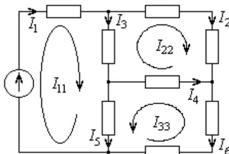
рассчитаны значения контурных токов  $I_{11}=5$  мА,  $I_{22}=8$  мА,  $I_{33}=12$  мА. Тогда токи ветвей  $I_1$ ,  $I_3$  и  $I_4$  принимают соответственно значения \_\_\_\_, \_\_\_\_ и \_\_\_\_ мА
