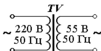
Коэффициент трансформации идеального трансформатора с указанными параметрами равен \_\_\_\_
