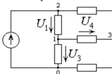
рассчитаны значения узловых напряжений  $U_{11}=7$  В,  $U_{22}=8$  В,  $U_{33}=11$  В. Тогда напряжения  $U_1$ ,  $U_3$  и  $U_4$  на концах ветвей принимают значения \_\_\_\_, \_\_\_\_, \_\_\_\_ В.
