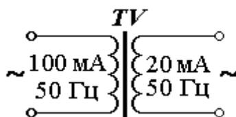
Коэффициент трансформации идеального трансформатора с указанными параметрами равен \_\_\_\_
