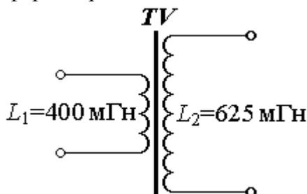
Коэффициент трансформации идеального трансформатора с указанными параметрами равен \_\_\_\_
