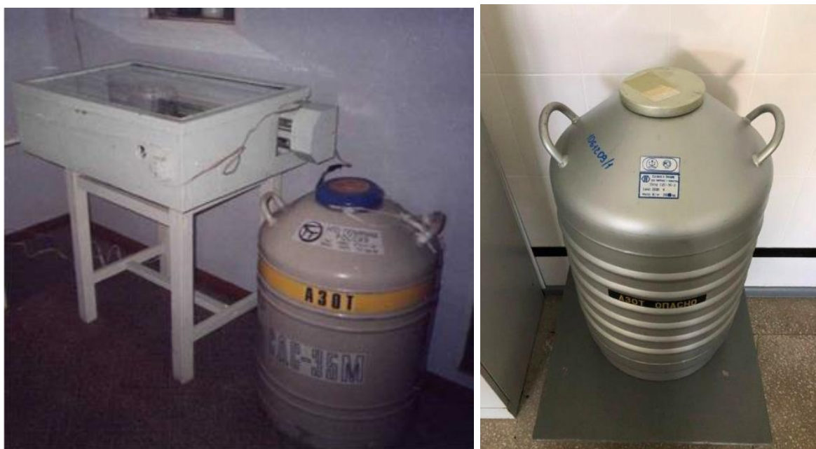
Рисунок 42 – Сосуды Дьюара на пункте искусственного осеменения
