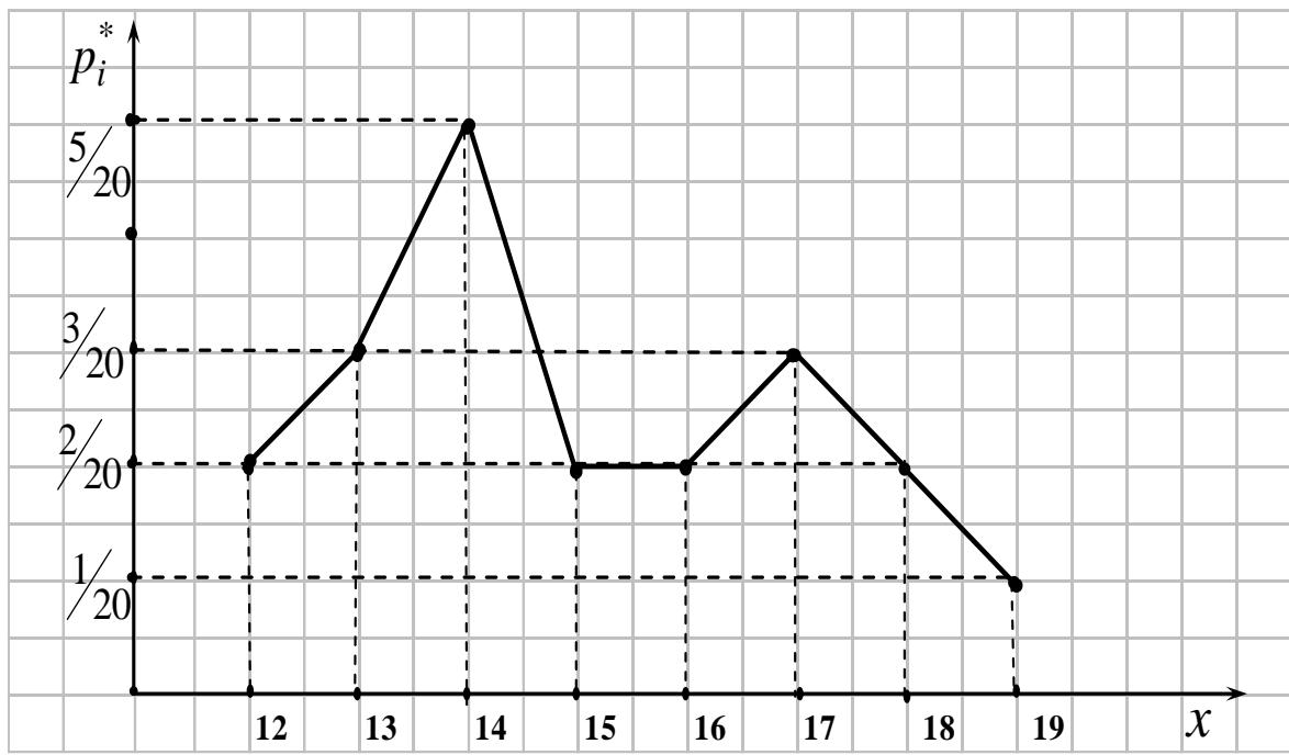
**Пример.** Результаты измерений отклонений от нормы диаметров 50 подшипников дали численные значения ( в мкм ).
