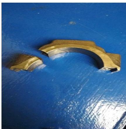
Рисунок 60. Фотография разрушенной верхней головки шатуна.
