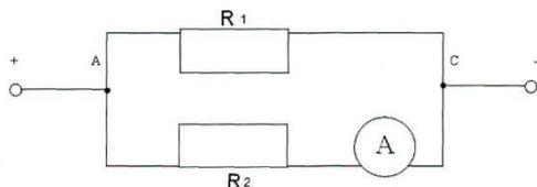
24. Найти мощность двух резисторов при последовательном и параллельном соединении при напряжении 220 В ( $R_1=R_2=80$  Ом) (начертить схемы).
