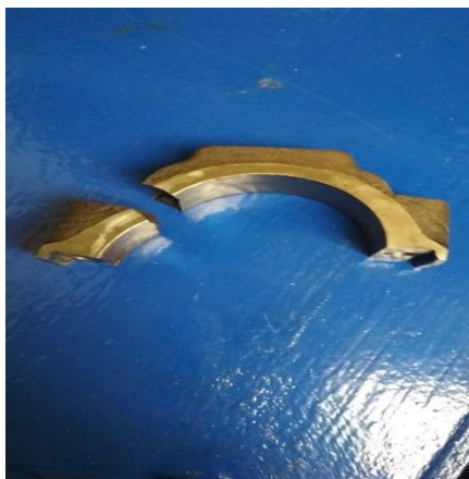
Рисунок 60. Фотография разрушенной верхней головки шатуна.
