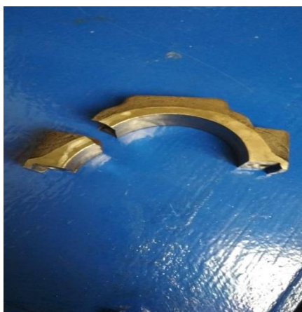
Рисунок 60. Фотография разрушенной верхней головки шатуна.
