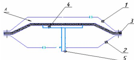
**Ответ: диафрагменный пневмопривод двухстороннего действия**
