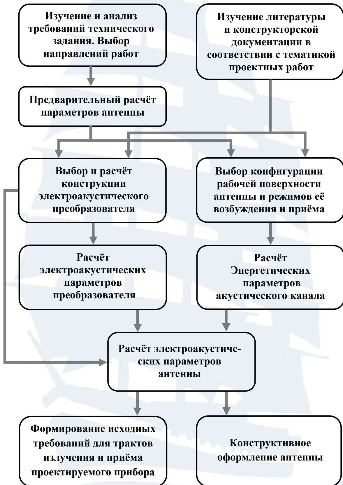
Рис. 1. Схема последовательности выполнения проектно-конструкторских работ
