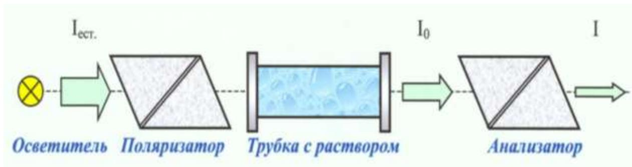
Рисунок 1 – Принципиальная схема установки
