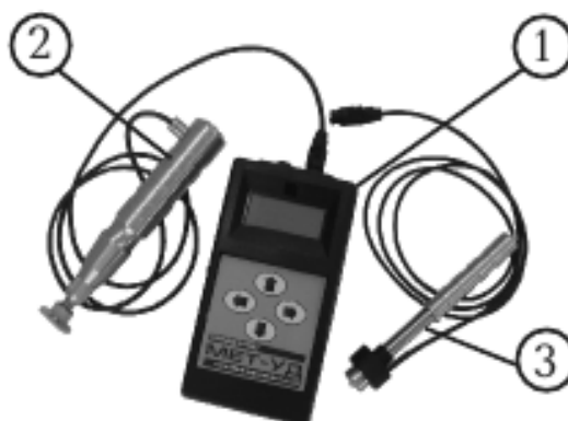
Рисунок 12 – Твердомер портативный комбинированный MET-УД:
