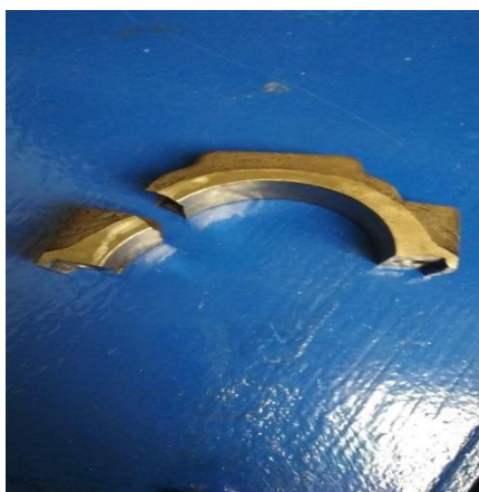
Рисунок 60. Фотография разрушенной верхней головки шатуна.
