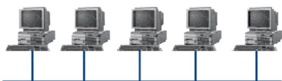
линии связи, и информация от каждого компьютера одновременно передается ко всем остальным компьютерам. Согласно этой топологии создается одноранговая сеть. При таком
