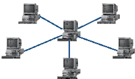
**Звезда (star)**, при которой к одному центральному компьютеру присоединяются остальные периферийные компьютеры, причем каждый из них использует свою отдельную линию связи. Весь обмен информацией идет исключительно через центральный компьютер, на который ложится очень большая нагрузка, поэтому он предназначен только для обслуживания сети.
