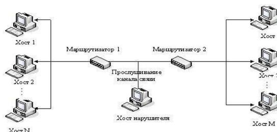
*Рис. - Схема реализации угрозы "Анализ сетевого трафика"*
