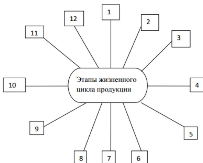
Рисунок 4.3 – Жизненный цикл продукции (петля качества): 1 – изучение спроса и требований к продукции (маркетинг); 2 – разработка продукции; 3 – планирование и разработка процессов; 4 – материально-техническое снабжение; 5 – производство; 6 – контроль и испытание; 7 – упаковка и хранение; 8 – продажа и доставка; 9 – монтаж и эксплуатация; 10 – техническое обслуживание и помощь; 11 – послепродажная деятельность; 12 – утилизация и переработка
