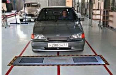
Стенд проверки подвески представляет собой платформу, состоящую из двух испытательных площадок, каждая из которых соединена с эксцентриковым валом.
