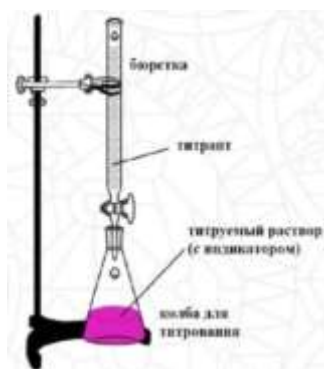
Рисунок 2. Установка для титрования. Титрант – например, раствор соляной кислоты или раствор щелочи
