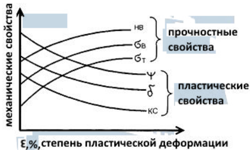
Рис. 2.5. Влияние степени деформации на механические свойства металла
