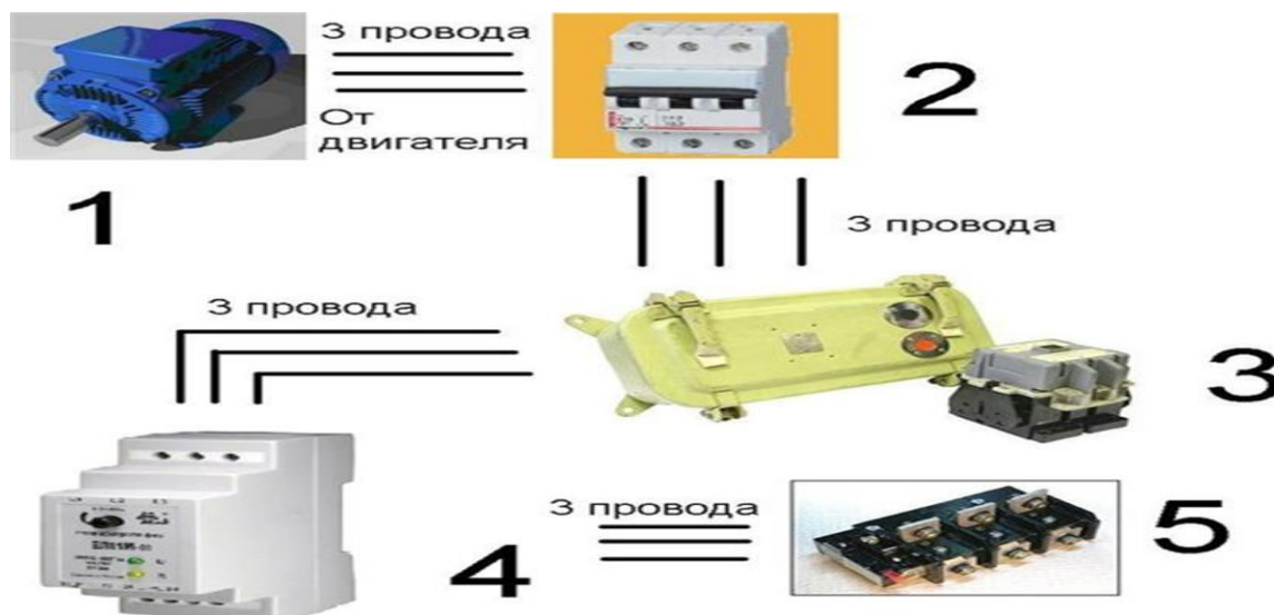
Рисунок 1 Схема электропривода механизма
