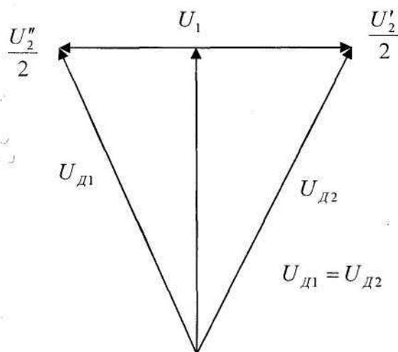
Напряжения, приложенные к диодам равны, следовательно, при симметрии плеч напряжения заряда конденсаторов, будут равны. Когда диоды VD1 и VD2 закрываются, происходит заряд C7 токами, протекающими в противоположных направлениях. Результирующее напряжение на C7 равно нулю, т.к. токи разряда C4 и C5 одинаковы, поскольку  $U_{C4} = U_{C5}$ . Т.о., в режиме несущей на выходе дробного детектора напряжение равно нулю.
