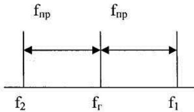
Меньшая из двух частот является  $f_{c\min}$  для верхней настройки Гетеродина, а частота  $f_1$  - зеркальный канал. Полностью выведем ротор КПЕ и аналогичным путем
