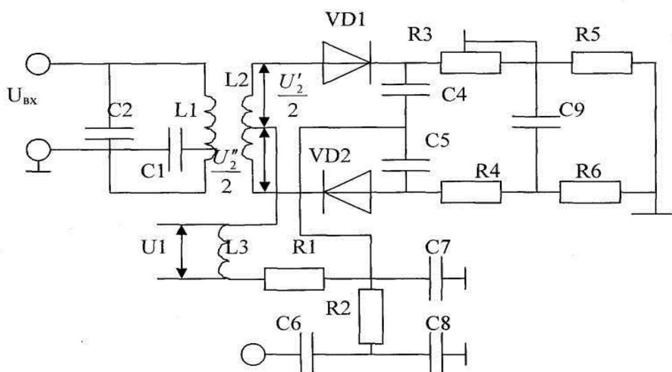
Дробный детектор (детектор отношений) обеспечивает выделение сигнала информации из частотно-модулированного сигнала. Дробный детектор обладает ограничивающими свойствами, поэтому перед ним нет необходимости ставить амплитудный ограничитель для срезания паразитной амплитудной модуляции. Поэтому дробный детектор обладает повышенной чувствительностью, т.к. для нормальной работы амплитудного ограничителя требуется довольно большое напряжение сигнала (1 ... 2 В).
