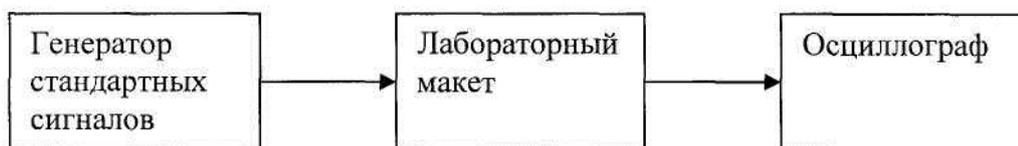
2. Найти рабочий диапазон входной цепи. Для этого следует полностью ввести ротор КПЕ и, перестраивая генератор, добиться на экране осциллографа максимального сигнала. Частота, подаваемая с генератора, будет  $f_{\min}$ . Затем полностью выводим ротор КПЕ и аналогичным путем находим  $f_{\max}$ .
