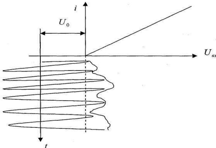
При большей амплитуде угол отсечки  $\theta$  также больше, а коэффициент передачи детектора  $K_d = \cos \theta$  будет меньше. Т.о., увеличение амплитуды (за счет паразитной амплитудной модуляции) приведет к уменьшению  $K_d$  и наоборот. В результате происходит сглаживание паразитной амплитудной модуляции.
