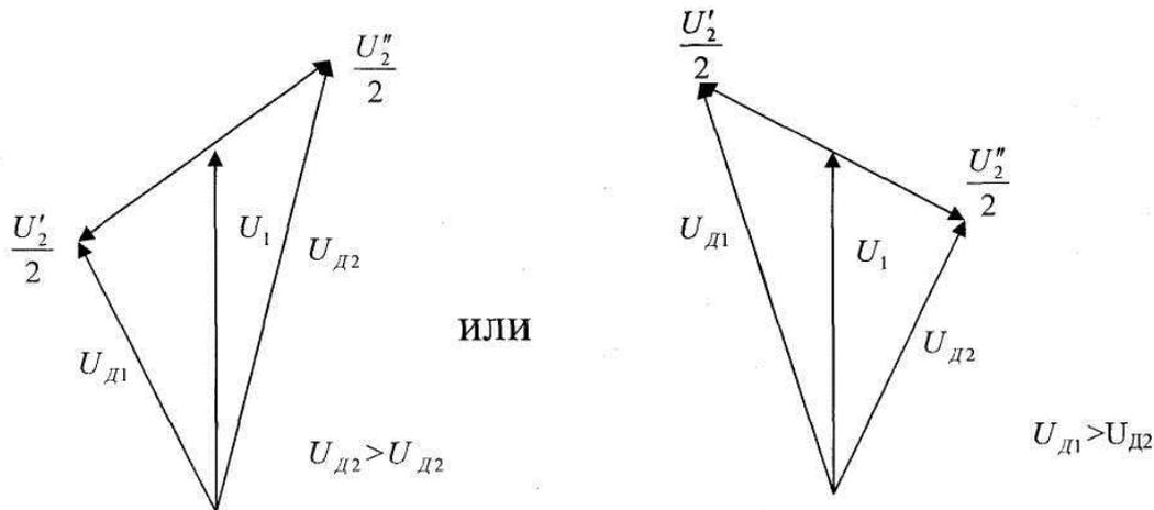
Характер векторной диаграммы зависит от того, положительная или отрицательная полуволна напряжения действует в данный момент (имеется в виду модулирующий сигнал), а также от величины модулирующего сигнала, т.к. от этих факторов зависит знак отклонения частоты и величина этого отклонения.
