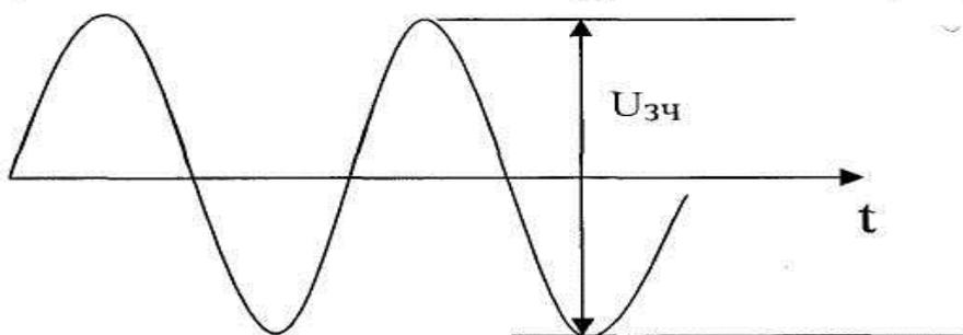
Коэффициент передачи детектора  $k_d = \frac{U_{зч} [\text{мм}]}{\Delta U [\text{мм}]}$  диодного детектора меньше
