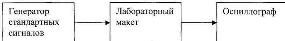
5. На генераторе включаем внутреннюю модуляцию и устанавливаем  $m \approx 0,5$ , частота несущей около 500 кГц. Закорачиваем гнезда «прибор» на макете. С помощью осциллографа, подключенного на вход детектора, измеряем  $\Delta U$  (в мм):
