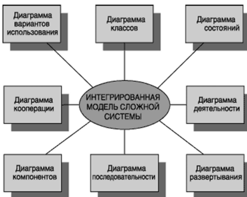
Рисунок 5 – Интегрированная модель сложной системы в нотации UML
