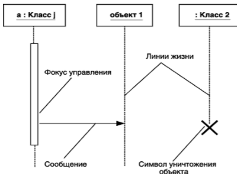
Рисунок 6 – Графические элементы диаграммы последовательности
