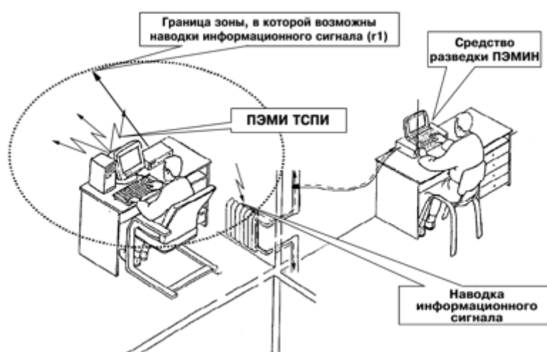
Рисунок 3 – Перехват наведенных электромагнитных излучений ТСПИ с посторонних проводников (инженерных коммуникаций)
