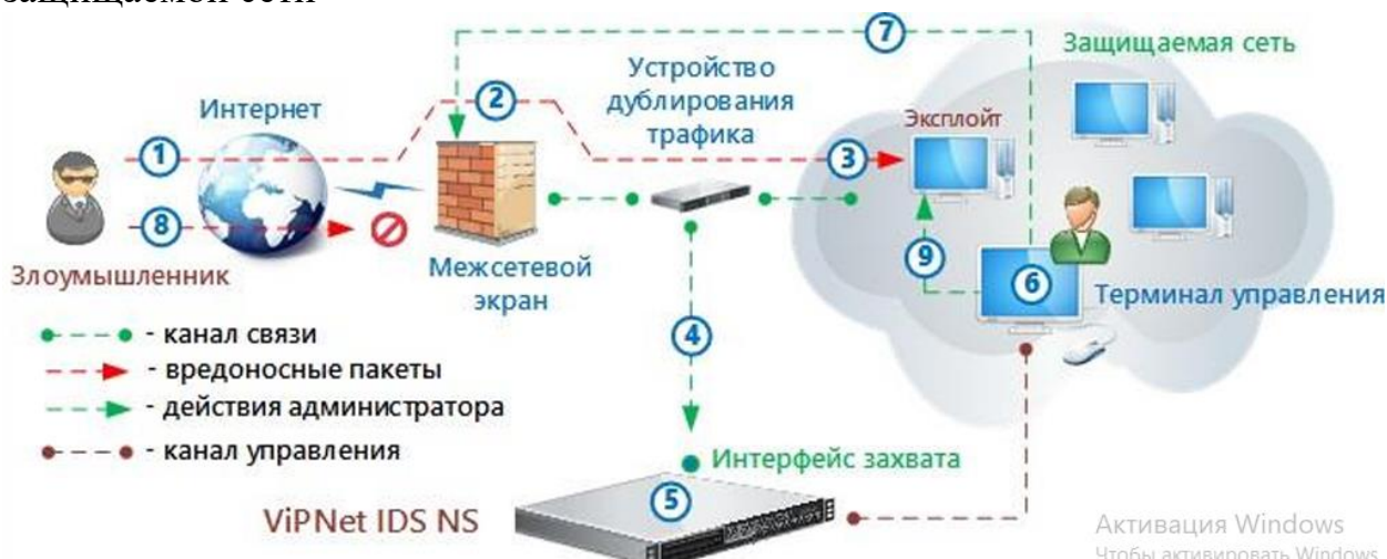
Рисунок 7 – Принцип работы COB
